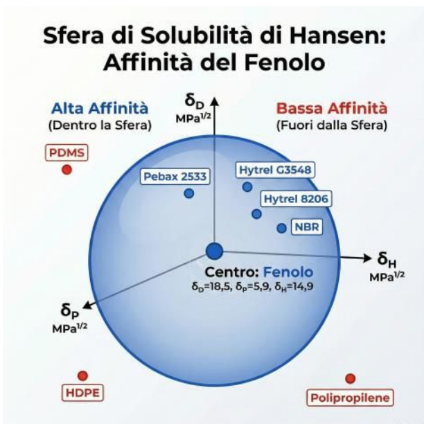
Figura 1. Sfera di solubilità del fenolo e di una serie di polimeri commerciali (Hytrel® G3548, Hytrel® 8206, Pebax® 2533) e puri (Polipropilene, PDMS: polidimetilsilossano o gomma siliconica, HDPE: polietilene ad alta densità, NBR: gomma nitrilica) In blu i polimeri con RED <1, in rosso quelli con RED >1. (Immagine generata con NotebookLM).
