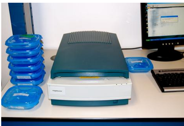
Figura 5. Scanner e workstation dedicati per l'acquisizione dei gel per la successiva analisi statistica delle immagini.
