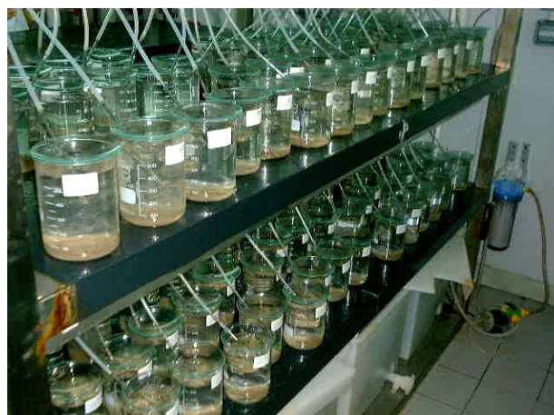
Figura 2. Esecuzione del test acuto con M. insidiosum per la valutazione della qualità di sedimenti marini tal quali
