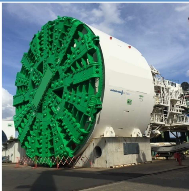
Foto 1. Immagine di una fresa meccanica di tipo TBM-EPB.
