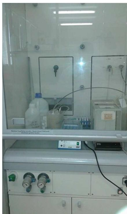
**Figura 3.** Allestimento del reattore di digestione del COD
