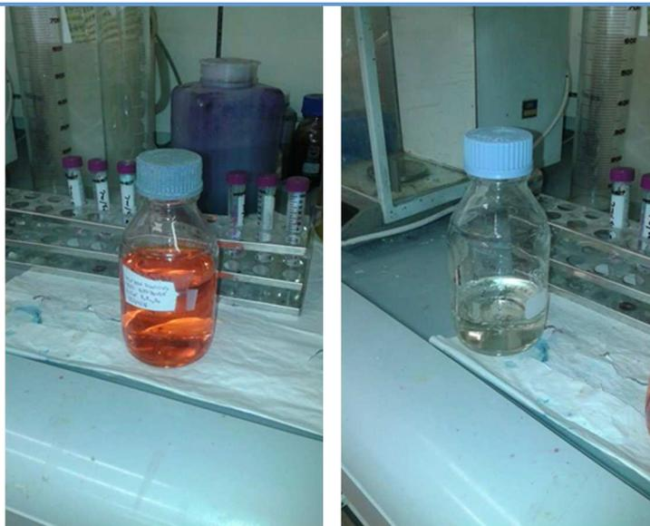
**Figura 1.** Reattivi: a sinistra, soluzione 2.2.1 ( $K_2Cr_2O_7$ , 0,250 N), a destra soluzione 2.2.2 (Soluzione acida:  $H_2SO_4$  addizionato di  $Ag_2SO_4$ )
