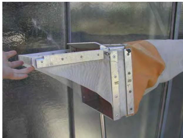
Fig. 6b. Dettaglio relativo all'intelaiatura quadrata aggiunta al retino per la raccolta quantitativa del benthos (Foto APPA BZ).
