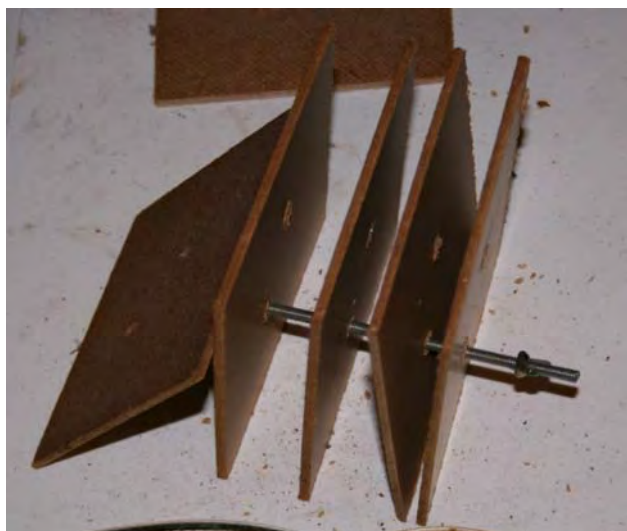
Fig. 2. Singolo SA in fase di assemblaggio: le lamelle di faesite sono ancorate tra loro al centro mediante una o due barre filettate metalliche; nell'esempio riportato in fotografia, tra le lamelle non sono inseriti i distanziatori per consentire l'osservazione della barra.
