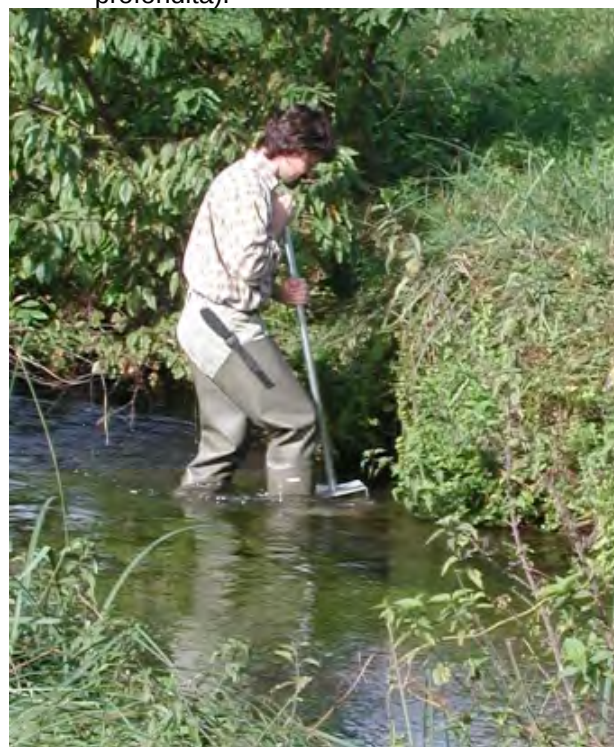
Fig. 13. Campionamento con retino immanicato, utilizzando i piedi per smuovere il substrato.
