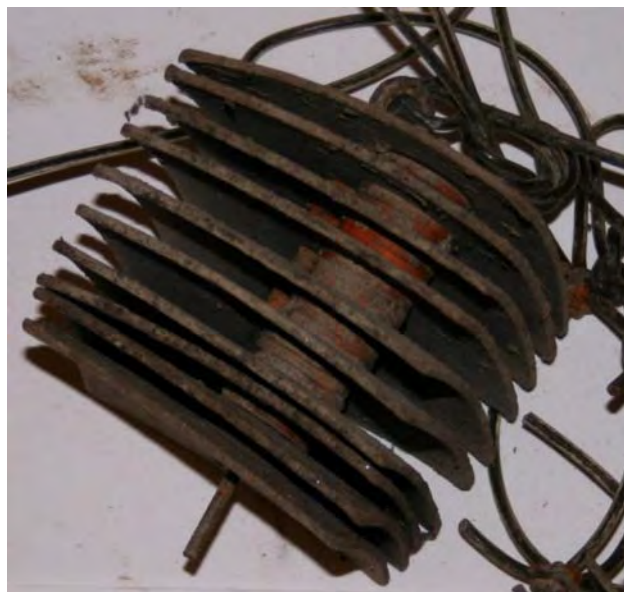
Fig. 3. Dettaglio di come le lamelle tra loro possano offrire spazi di ampiezza diversa, adatti ad organismi bentonici di diversa taglia; a questo riguardo, si veda anche Fig. 4. I diversi spazi che risultano così tra le lamelle permettono una colonizzazione differenziata delle diverse zone del substrato artificiale da parte degli organismi macrobentonici secondo le dimensioni corporee e le esigenze idrauliche dei singoli taxa.
