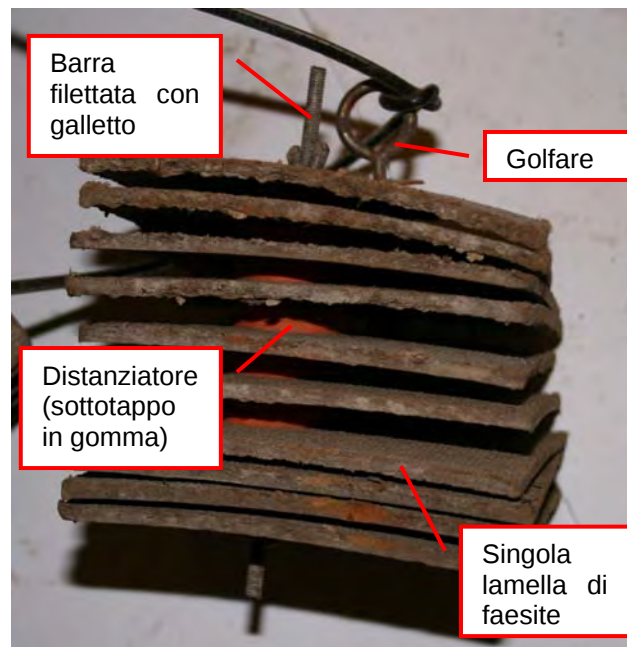
Fig. 4. Singolo SA assemblato, con lamelle a diversa distanza tra di loro nei tre settori del substrato (vedi testo); in figura è riportato un substrato già impiegato parecchie volte e che ha perciò avuto una permanenza in acqua abbastanza lunga i.e. complessivamente oltre i sei mesi.
