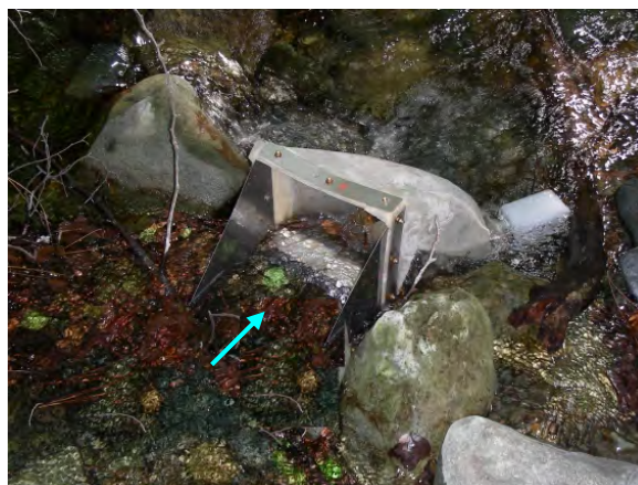
Fig. 5. Posizionamento della rete Surber per il campionamento. La freccia blu indica la direzione del flusso.
