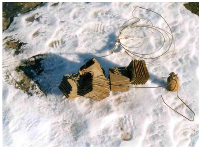
Fig. 6. Altro esempio di gruppo di 5 substrati artificiali (SA) con peso.
