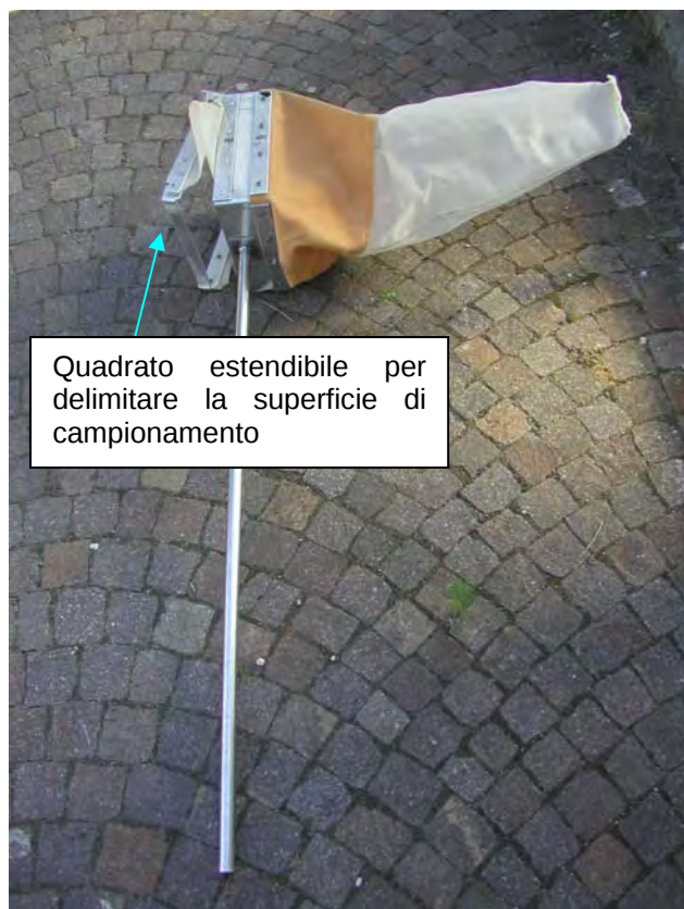
Fig. 6a. Retino immanicato modificato per la raccolta quantitativa del benthos (Foto APPA BZ).
