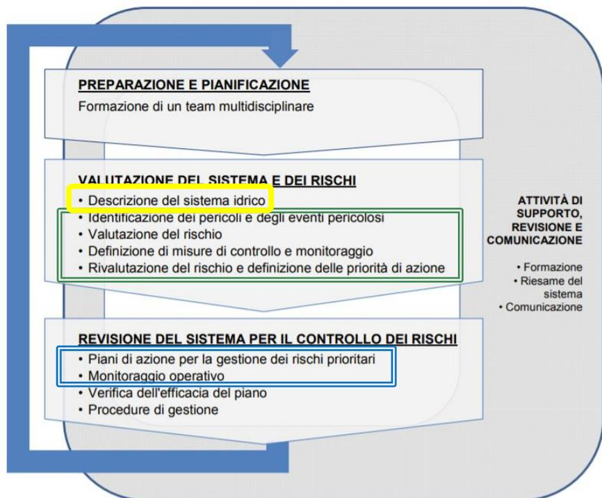
Figura 2. Rappresentazione schematica delle fasi di un PSA
